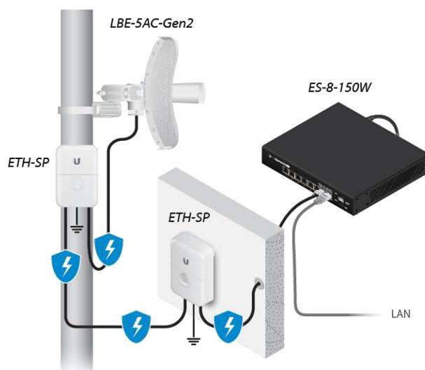
El LiteBeam AC montado en el exterior con el reflector instalado proporciona cobertura exterior direccional (la ganancia depende del reflector).
