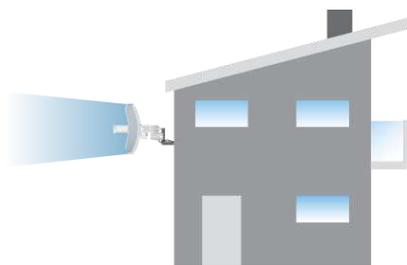
El LiteBeam AC montado en el exterior sin el reflector instalado proporciona cobertura solamente del exterior al interior a través del bocina de alimentación de 3 dBi.
