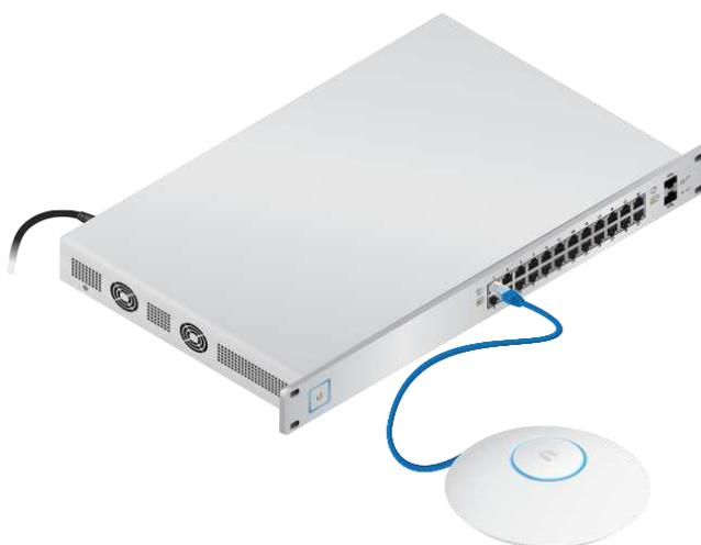
Diagrama de conexión de alimentación a un interruptor UniFi con PoE
